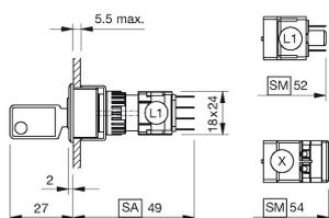
L1 = Löt-/Steckanschluss 2.8 x 0.5 mm
