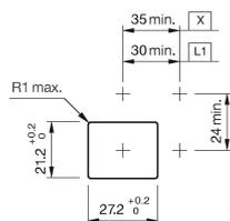
L1 = Löt-/Steckanschluss 2.8 x 0.5 mm
