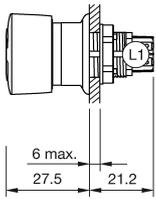
L1 = Löt-/Steckanschluss 2.8 x 0.5 mm
