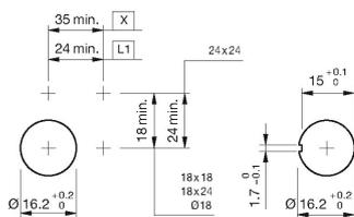
L1 = Löt-/Steckanschluss 2.8 x 0.5 mm
