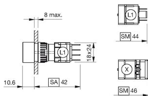
L1 = Löt-/Steckanschluss 2.8 x 0.5 mm
