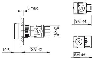
L1 = Löt-/Steckanschluss 2.8 x 0.5 mm
