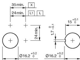
L1 = Löt-/Steckanschluss 2.8 x 0.5 mm
