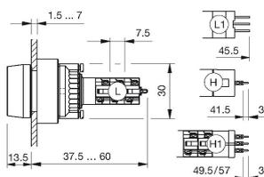
L1 = Löt-/Steckanschluss 2.8 x 0.5 mm
