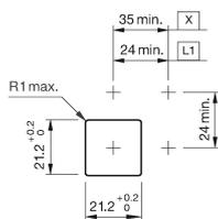
L1 = Löt-/Steckanschluss 2.8 x 0.5 mm
