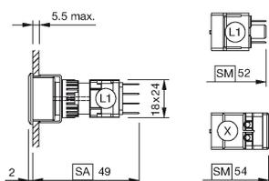
L1 = Löt-/Steckanschluss 2.8 x 0.5 mm
