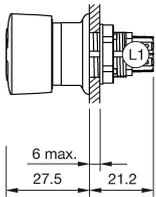
L1 = Löt-/Steckanschluss 2.8 x 0.5 mm
